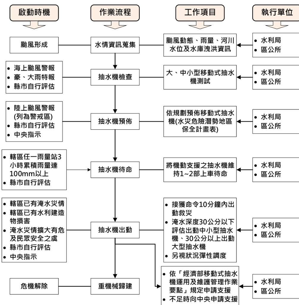
圖 3-3、移動式抽水機運用流程圖
