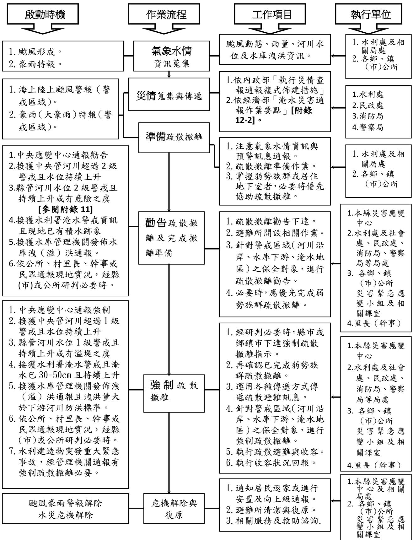
圖 3-4、水災疏散撤離作業流程圖
